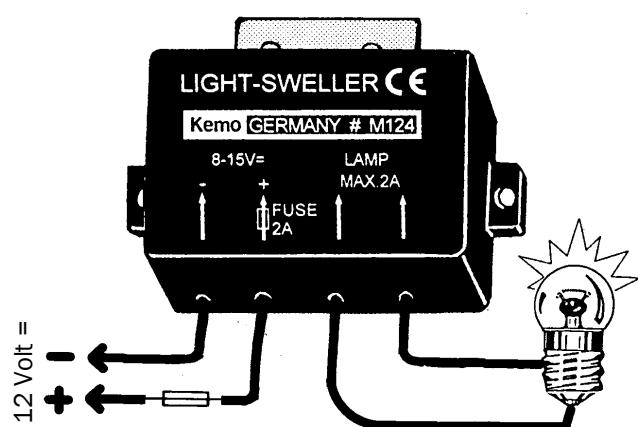
Sicherung 2A / Fuse 2A
